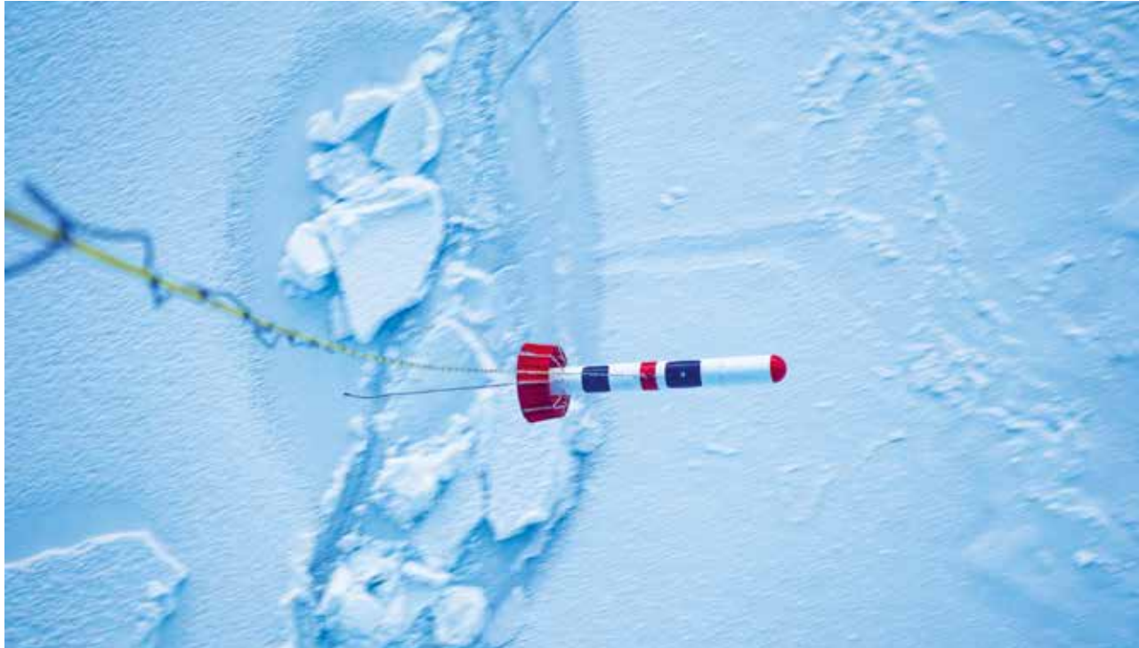
Der Meereisdickensensor EM-Bird sieht wie ein Torpedo aus und wird vom Hubschrauber oder Flugzeugen an einem langen Seil hängend (Hubschrauber 20 Meter, Flugzeug 80 Meter) über das Eis geschleppt. Er schwebt dann in etwa 15 Meter Höhe über dem Eis.
