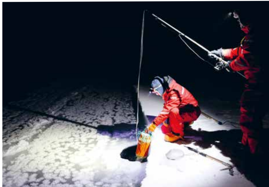
Als sich am Morgen des 23. Januar 2020 eine Rinne im Meereis bildet, greifen die Ozeanographen Dr. Volker Mohrholz und Dr. Benjamin Rabe zur Angel und lassen eine Mikroturbulenzsonde in die Tiefe. Die Sonde misst die Temperatur, den Salz- und Sauerstoffgehalt sowie Verwirbelungen des Wassers.
