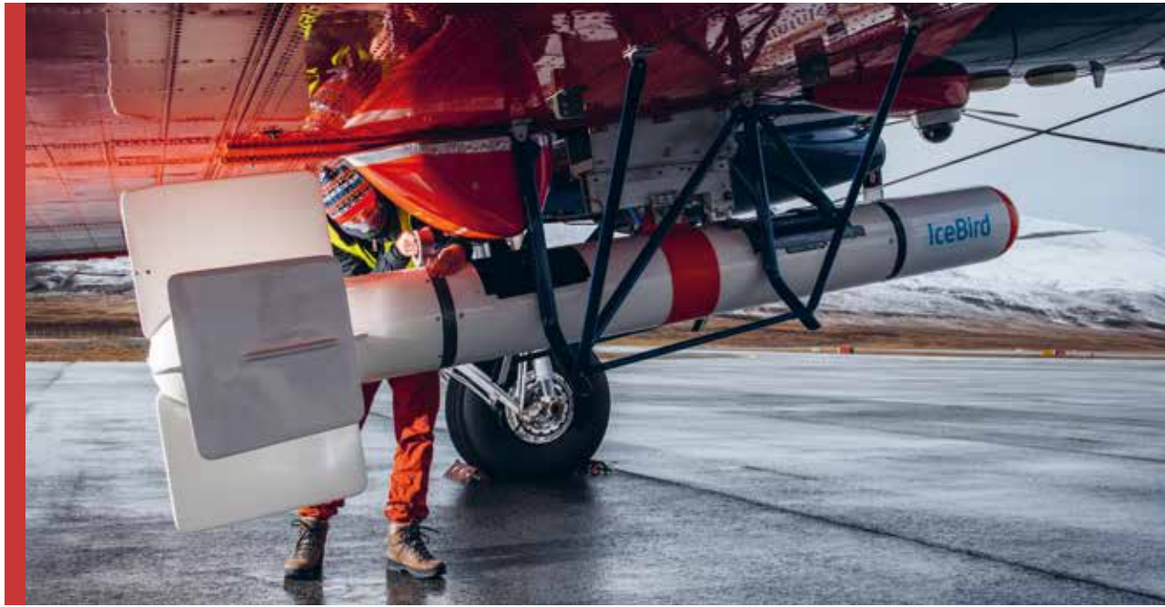
AWI-Meereisphysiker Jakob Belter wartet auf dem Flughafen von Longyearbyen den Meereisdickensensor EM-Bird. Dieser hängt zu diesem Zeitpunkt in seiner speziellen Start- und Landehalterung, die am Rumpf des Forschungsflugzeuges POLAR 6 angebracht ist.
